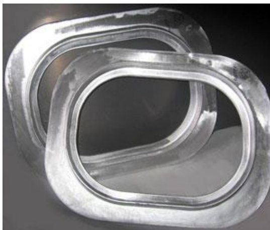
Рисунок 6 - Штамповка - окантовка иллюминатора - из сплава 1420ТГ1
